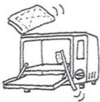
汚れた反発板はトースターの熱効率の低下の原因に
